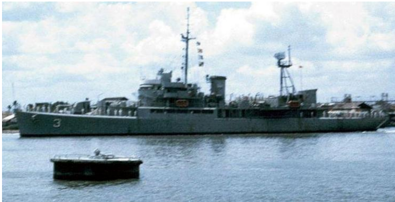
TDH Trần Nhật Duật (HQ3). Displacement (trọng tấn - full) 2,750 Tons, LOA (dài): 311 ft, Beam (ngang) 41 ft, Draft (sâu) 13.5 ft. Speed (vận tốc) 18.2 Knots (gút)
